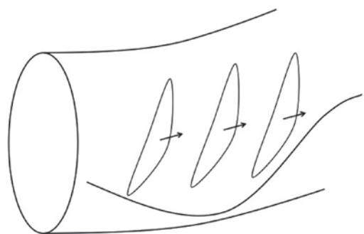
図6 捕捉粒子がつくるグラニュレーションの概念図。トロイダル方向に歳差運動を行っているバナナ粒子が、共鳴によって相関し、正味の粒子塊として振る舞う。
